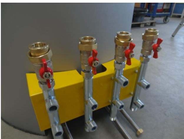
Optional dazwischen aufdichten der Kugelhähne mit 1" Verschraubung flach
