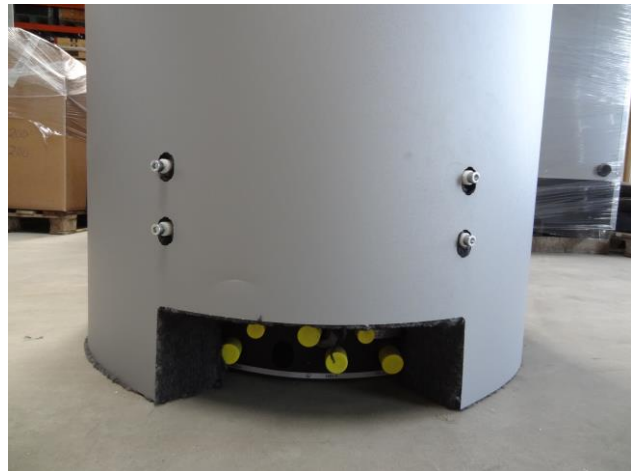
Montage der weißen Abstandhalter, Montage der Isolierung
